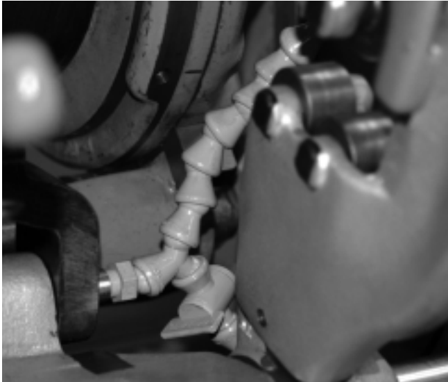
Figura 16A – Roscador a engranajes No. 141 acoplado directamente a una Roscadora 535 moderna empleando un Enlace del accionamiento. Fíjese en el pico del aceite acoplado al enlace.
