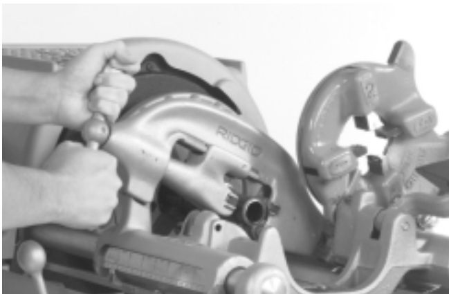
Figure 6 – Coupe des tuyaux à l'aide du coupe-tubes N° 820
